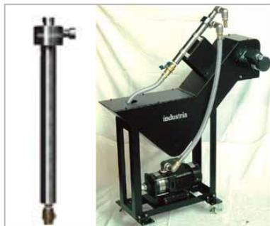
フィルスターを通してタンクに戻すだけで自動で濾過される装置。エレメントなしでメンテナンスフリー、つまりフィルターの交換がないのでメンテナンスコストがかからないという夢のような商品が開発されました。
